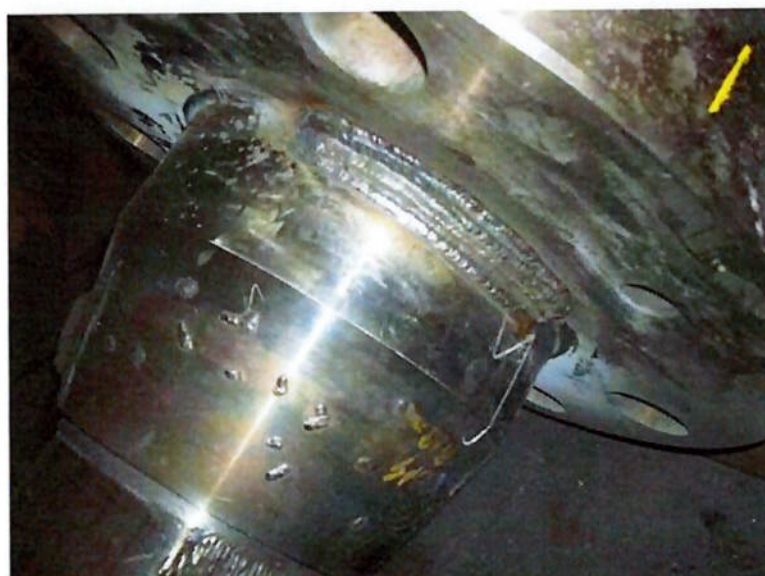
Figura 3.34 - Recuperação do diâmetro de 270 mm, poros e pontos com falta de fusão
