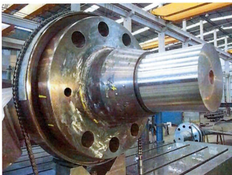
Figura 3.32- Usinagem para recuperação do munhão
