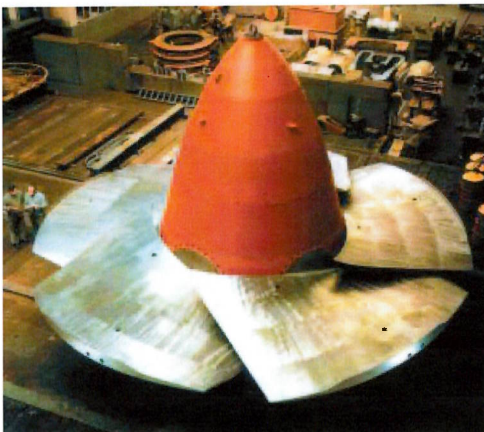
Figura 3.4- Rotor Kaplan UHE Jupiá D=8,4 mm, fonte Andritz Hydro do Brasil
