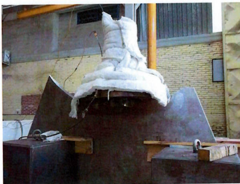
Figura 3.35 - Tratamento térmico para alívio de tensões pós soldagem
