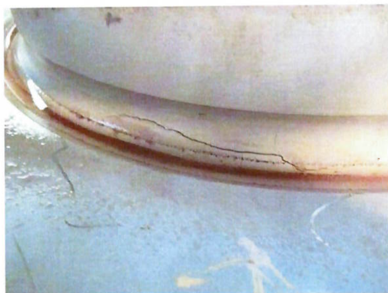
Figura 3.20 - Indicação encontrada na usinagem do munhão (PM)
