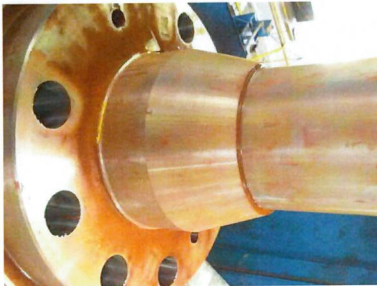
Figura 3.11 – Indicação linear detectada por PM
