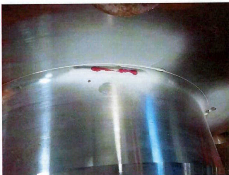
Figura 3.12 - Abertura da cavidade parcial, controle por líquido penetrante
