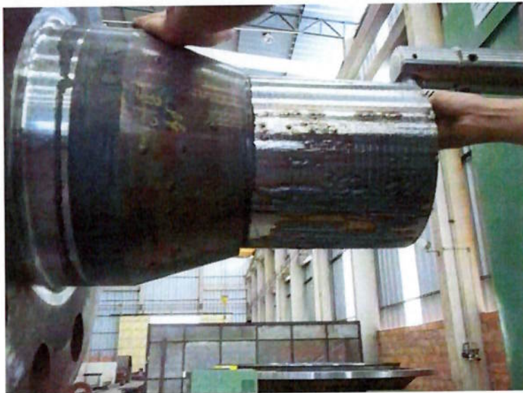
Figura 3.38 - Reparos feitos na superfície reconstituída
