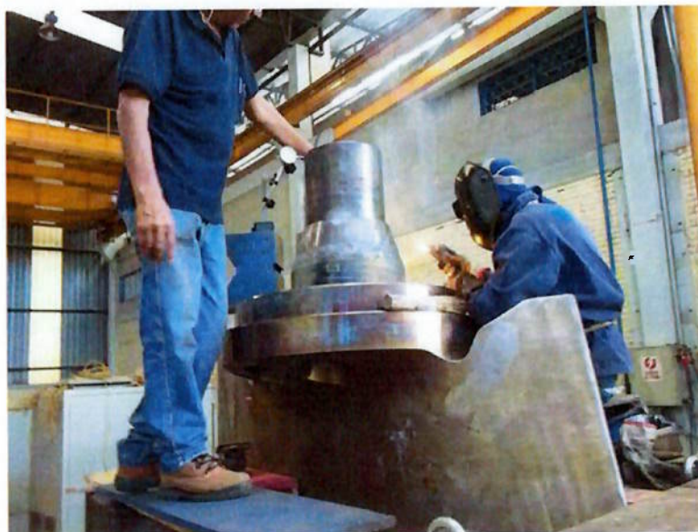
Figura 3.30 - Soldagem do diâmetro do munhão, raio de alívio
